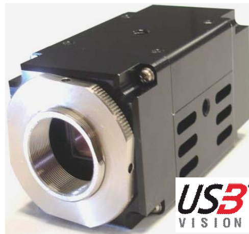
図5 ペルチエ冷却付き InGaAs 赤外カメラ フレームレート 60fps、USB3 Vision 適合。 50mm×100L 400g 波長感度900~1600nm、 最小感度10fW/pixels@1550nm。
